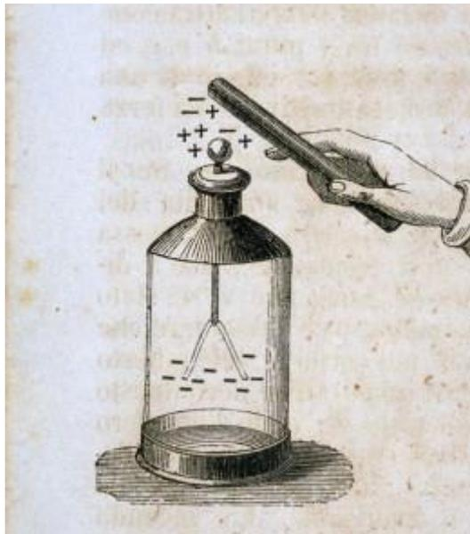
È costituito da un pomello metallico collegato, tramite un'asta metallica, a due sottili lamine metalliche chiamate “foglioline”.
